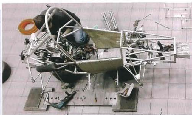
ДВА ДВИГАТЕЛЯ ГИБРИДА связаны по параллельной схеме: момент на ведущие колеса поступает как от электромотора (мощность – 22 кВт), так и от бензинового двигателя (8 кВт)
